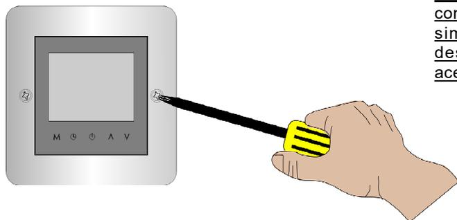
**2° Passo:** Pressionar o visor do comando touch e deslizar para cima simultaneamente, assim o desencaixando, dessa forma tendo acesso aos parafusos internos
