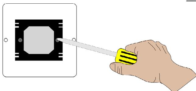
**4° Passo:** Retirar o comando touch digital para realizar a instalação elétrica na parte traseira do dispositivo
