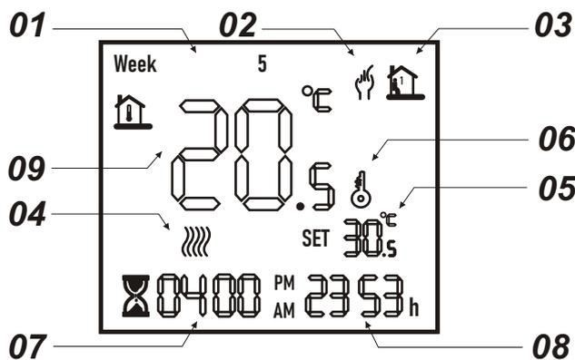
**Ajuste de temperatura desejada:** Aperte  $\wedge$  para aumentar e  $\vee$  para diminuir;
